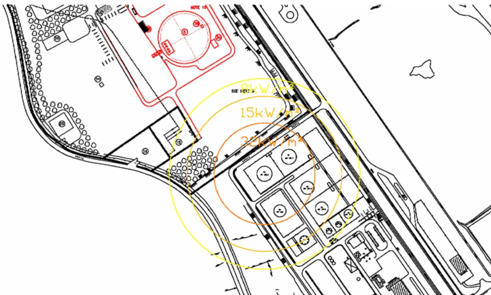
Slika 18: Zone od 32/15/8 \text{kW/m}^2 u slučaju požara lokve u tankvani EDC spremnika
