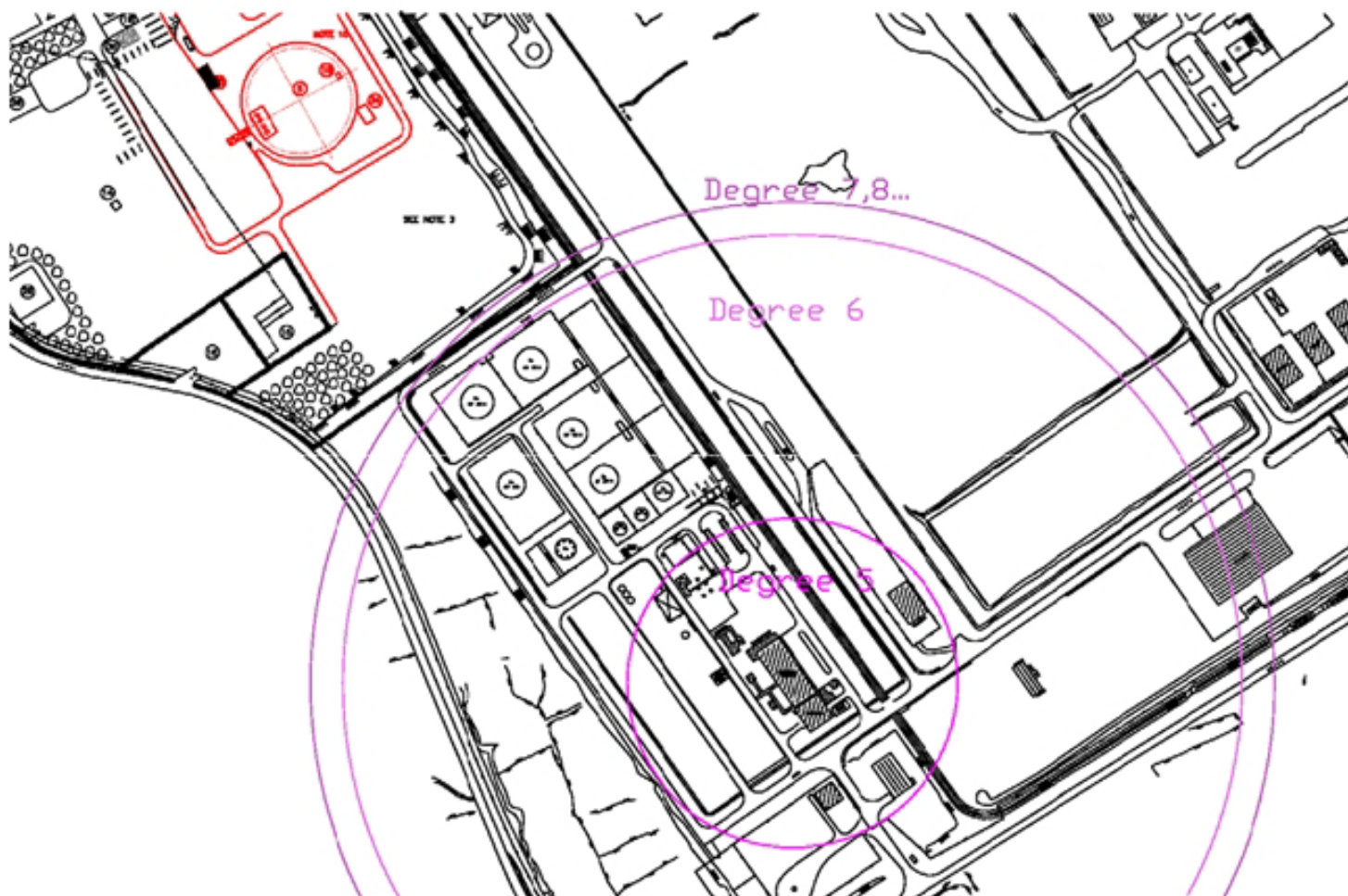
Slika 21: Zona pretlaka od 200 mbar u slučaju eksplozije oblaka pare na VCM postrojenju s različitim stupnjevima silovitosti
