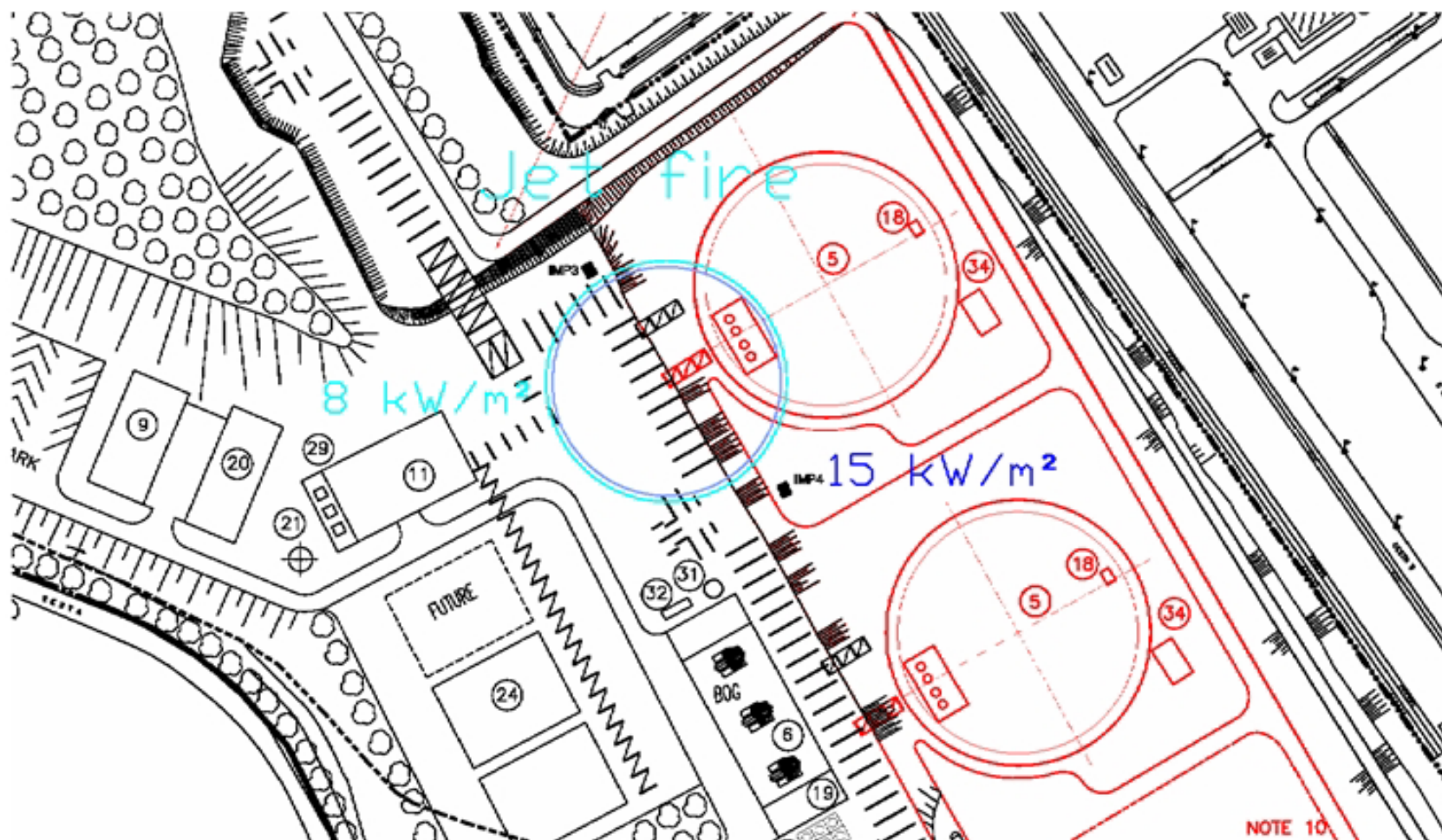
Slika 43: Zone od 15/8 kW/m 2 u slučaju požara mlaza kod puknuća ispusne cijevi kompresora
