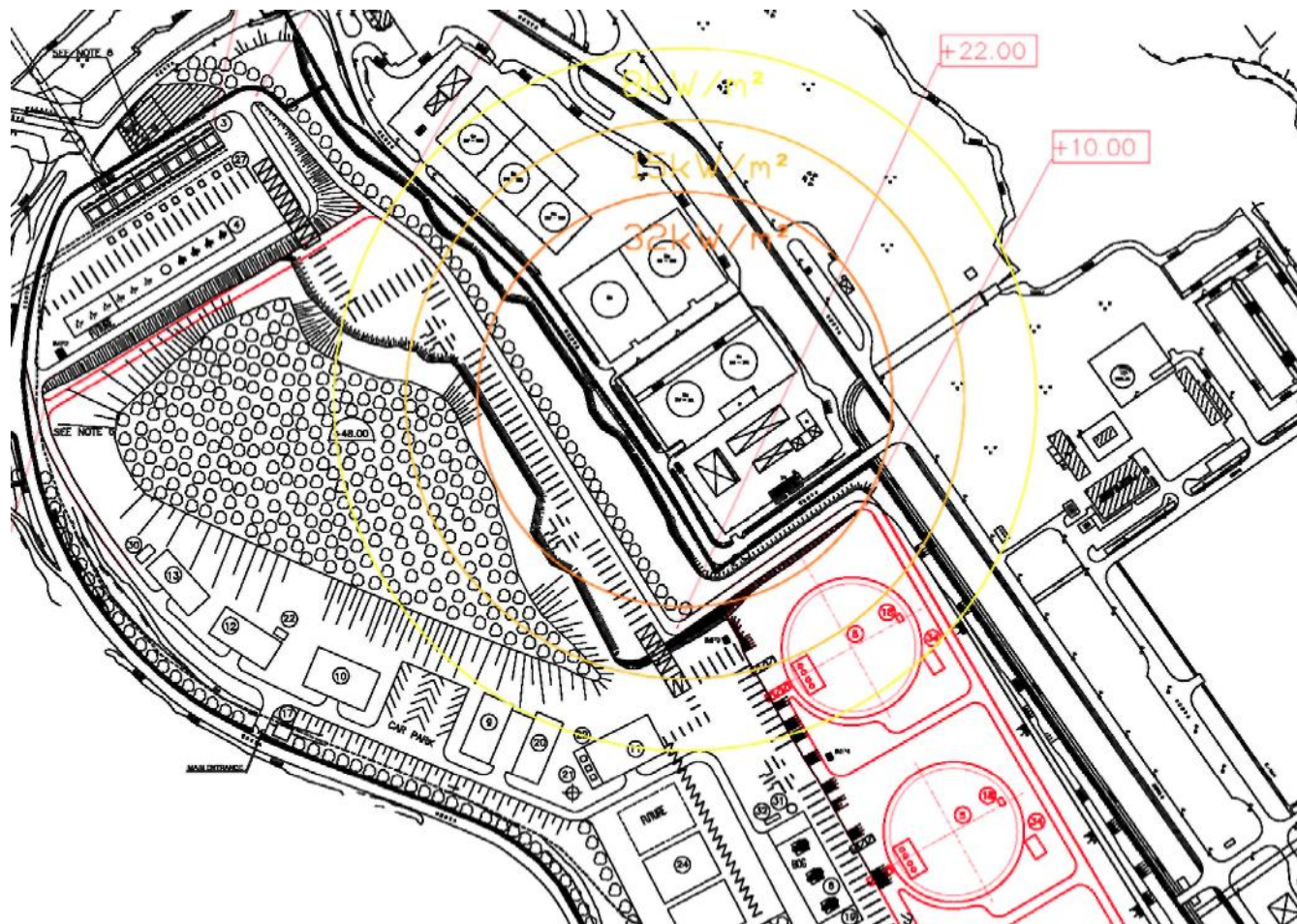
Slika 10: Zone od 32/15/8 kW/m 2 u slučaju požara lokve u području spremnika s etenom
